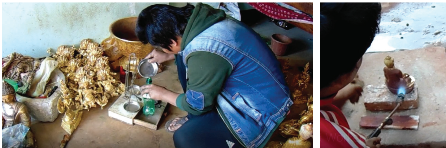
Figura 1. Trabajadores del enchapado en Nepal aplicando la pasta de mercurio/oro a estatuas y quemándola con un soplete. Fuente: CEPHEd
