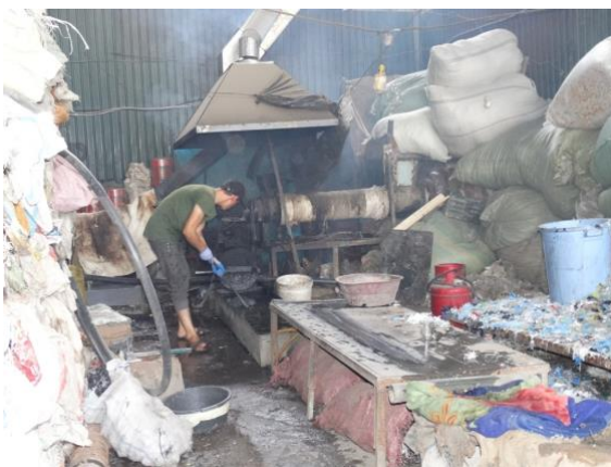
Душанбе - частная установка по утилизации пластика с получением гранул
