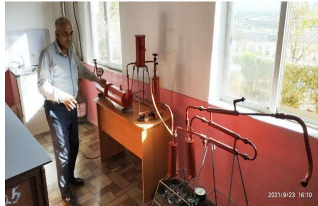
НИИ РТ-демонстрационная установка по пиролизу пластика
